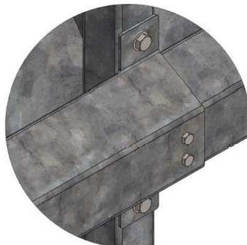
Figura 13: Dettaglio bulloni sacrificali lame
