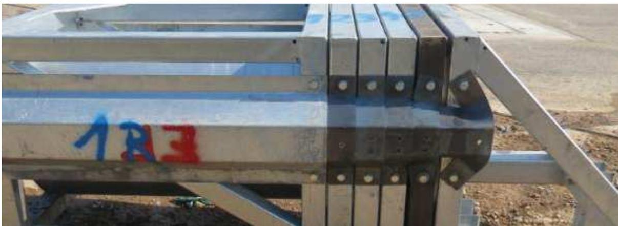
Figura 18: Attenuatore ZMP100S a seguito di crash test
