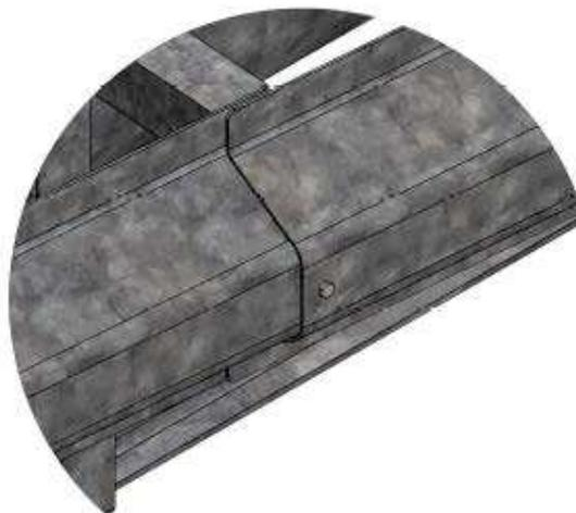
Figura 17: Dettaglio bulloni sacrificali lame dopo il modulo 3
