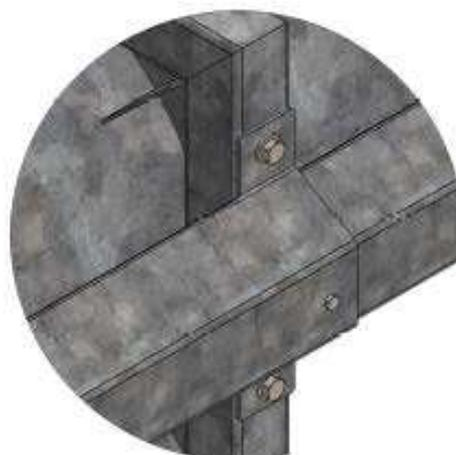
Figura 16: Dettaglio bulloni sacrificali lame fino al modulo 3
