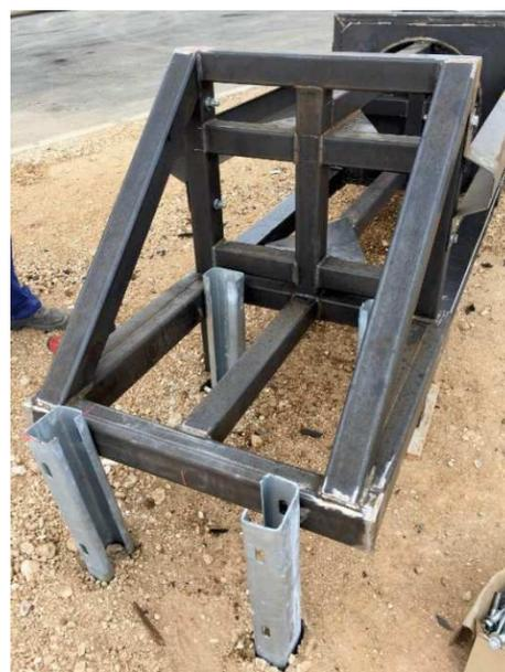
Figura 9: Collegamento posteriore pali 120x80mm
