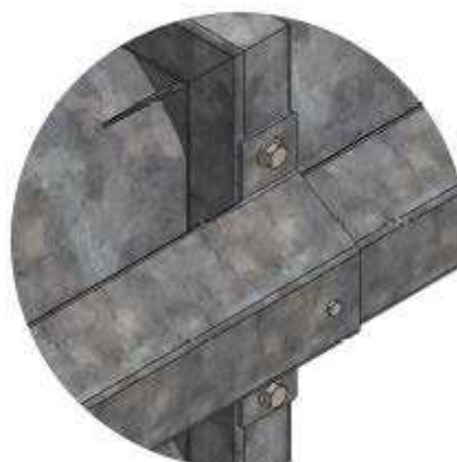
Figura 16: Dettaglio bulloni sacrificali lame
